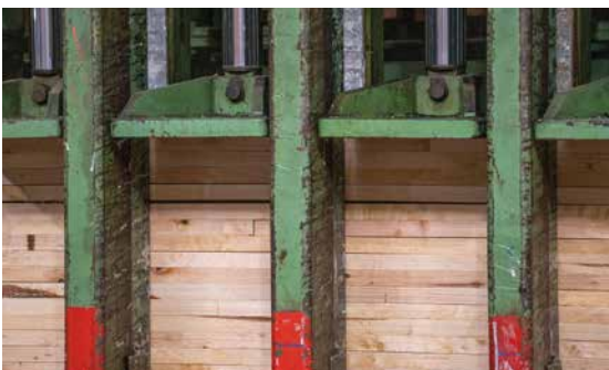
Fertigung des ersten Prototyps „Brettschichtholzträger aus Birke“ in der Produktion der Mayr-Melnhof Hüttemann Olsberg GmbH
