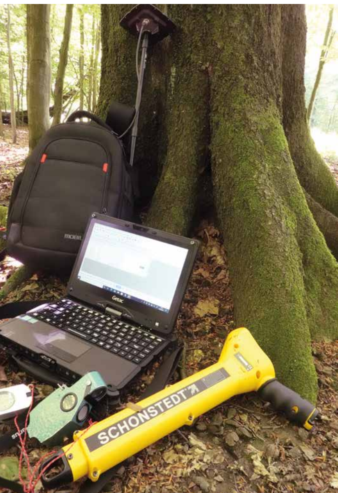
Abb. 1: GNSS-System, Feld-PC, Metallsuchgerät, Spiegelrelaskop, Busssole
