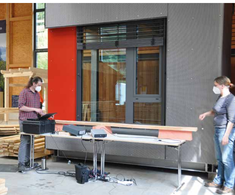
Abb. 3: Bestimmung des dynamischen Elastizitäts-Moduls mit Frau Prof. Frühwald
