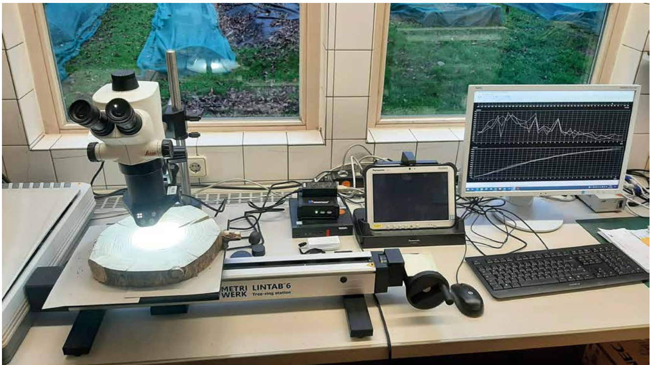
Abb. 2: Jahringanalyse an einer Fichte. Auf dem Bildschirm werden die Ringbreiten in Abhängigkeit der Jahre dargestellt.
