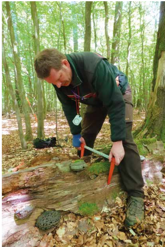
Abb. 4: Vermessung von Totholz mit Kluppe und Bandmaß
